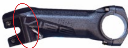
Afbeelding 2: in het klemgedeelte rond de stuurbuis kunnen scheuren ontstaan.
